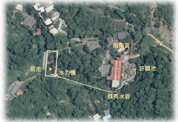
圖 現勘評估水力發電適合示範案場，以台北指南宮為例
